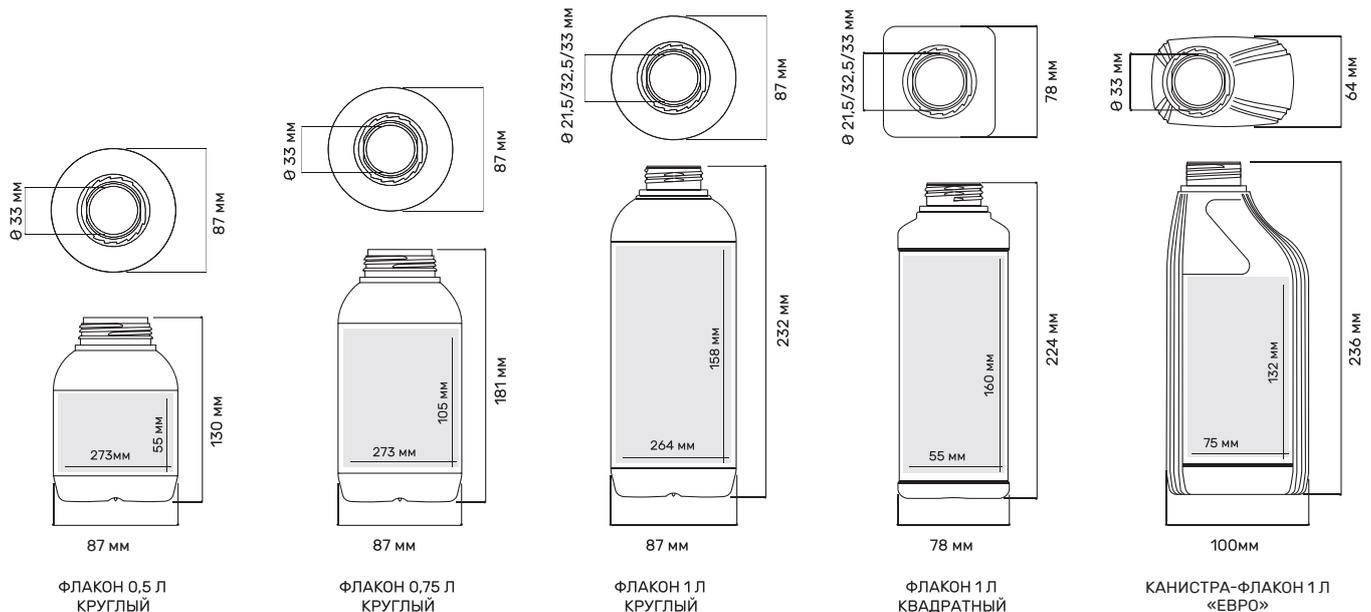
\* На чертежах обозначен внутренний диаметр горловины. Точные габариты изделий уточняйте у менеджера.
