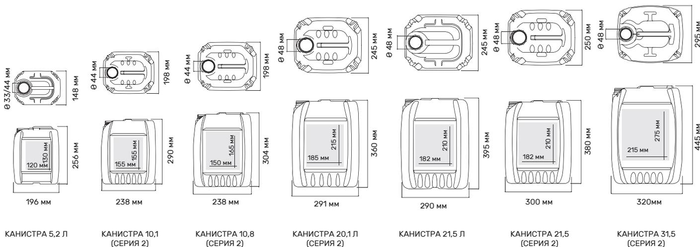
\* На чертежах обозначен внутренний диаметр горловины. Точные габариты изделий уточняйте у менеджера.
