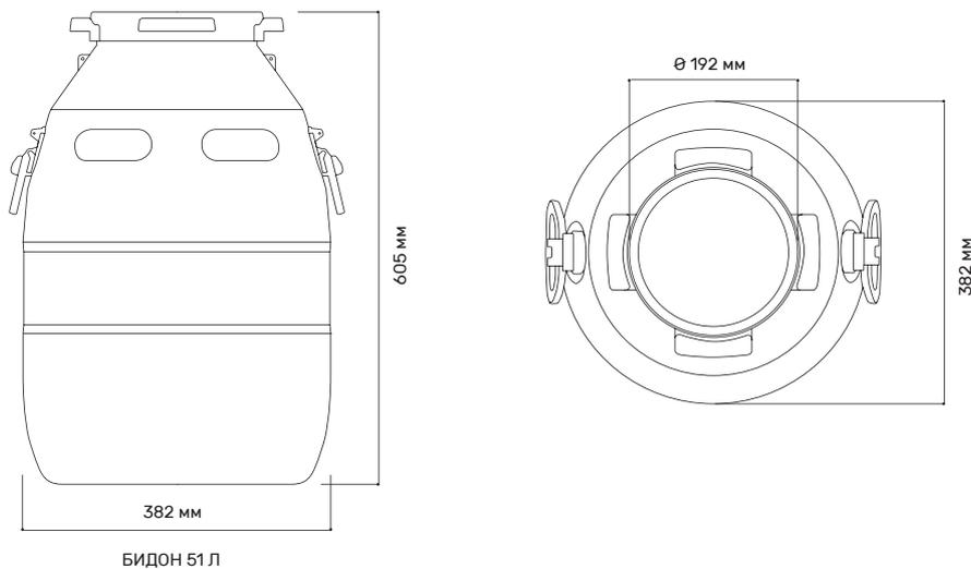
\* На чертежах обозначен внутренний диаметр горловины. Точные габариты изделий уточняйте у менеджера.
