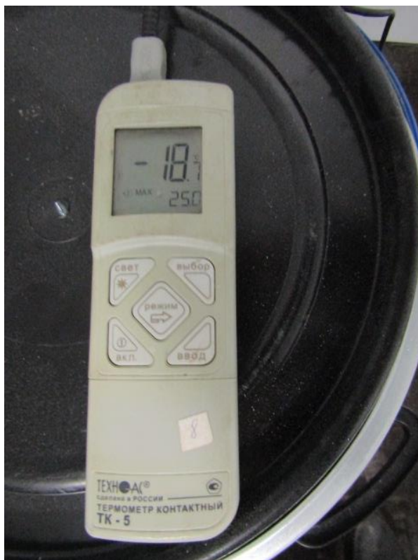
Фото П.2.2 – Подготовка образцов для испытаний (охлаждение в морозильной камере до температуры не выше -18^{\circ}\text{C} )
