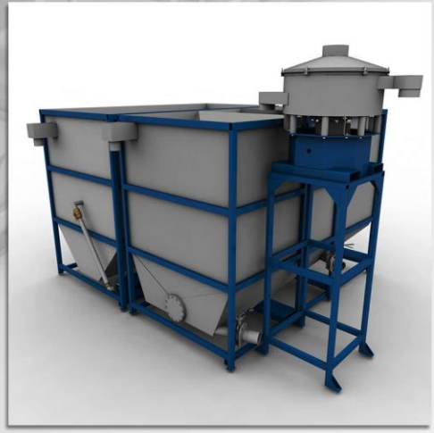
Ванна водоочистки ГП-ВО
