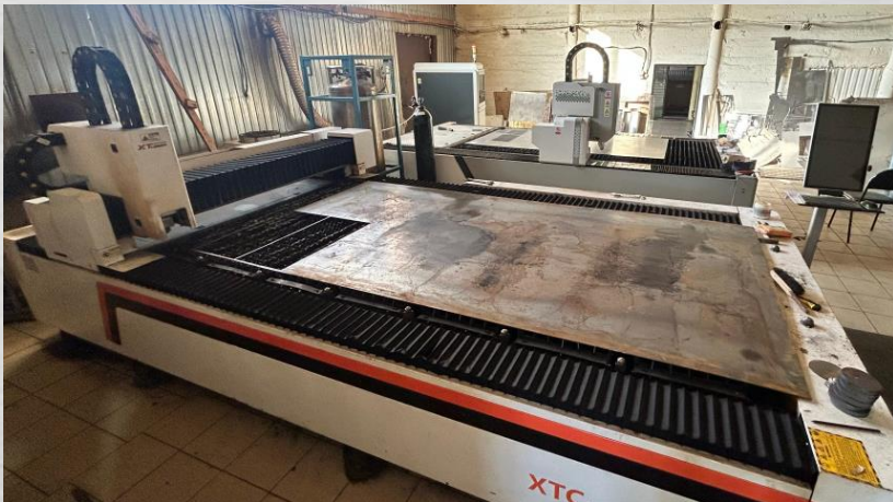
Станки лазерной резки – 2 единицы Размеры резки – 3000x1500x20
