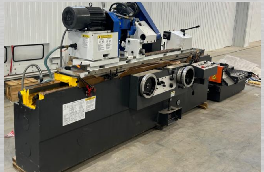
Кругло-шлифовальный Максимальный наружный диаметр – 320 mm Максимальный внутренний диаметр – 100 mm
