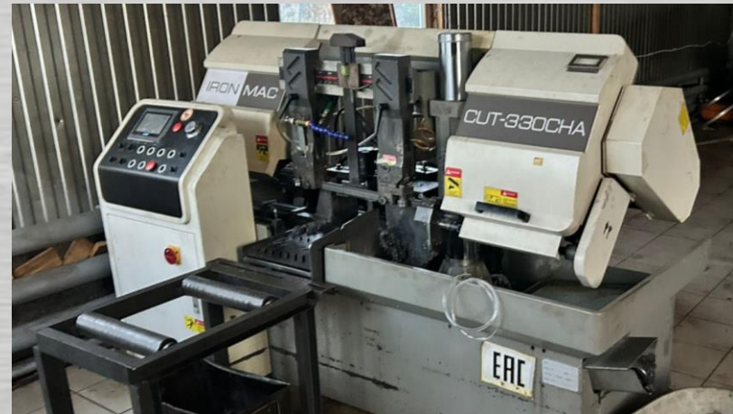
Автоматический ленточнопильный станок по металлу колонного типа IRONMAC CUT 330 Размеры резки – до 530 мм
